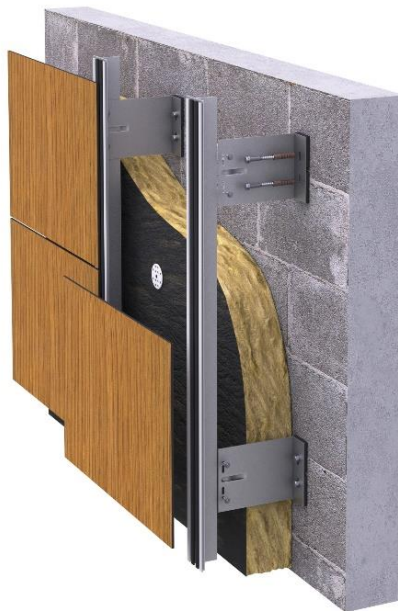
Рис. 6.4. Вентильований фасад з HPL-панелей [29]
