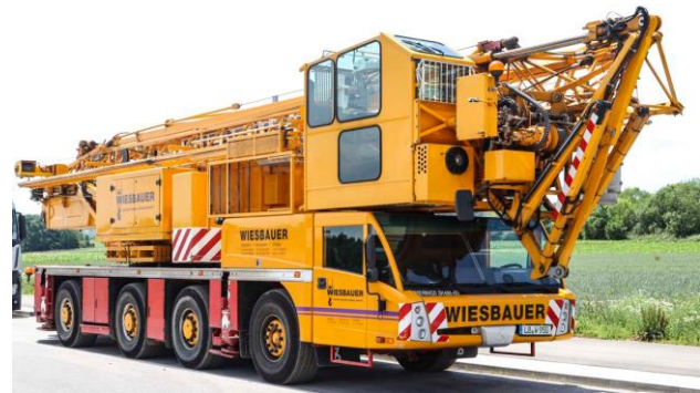
Рисунок 1. Кран Spierings SK498-AT4 в транспортному положенні
