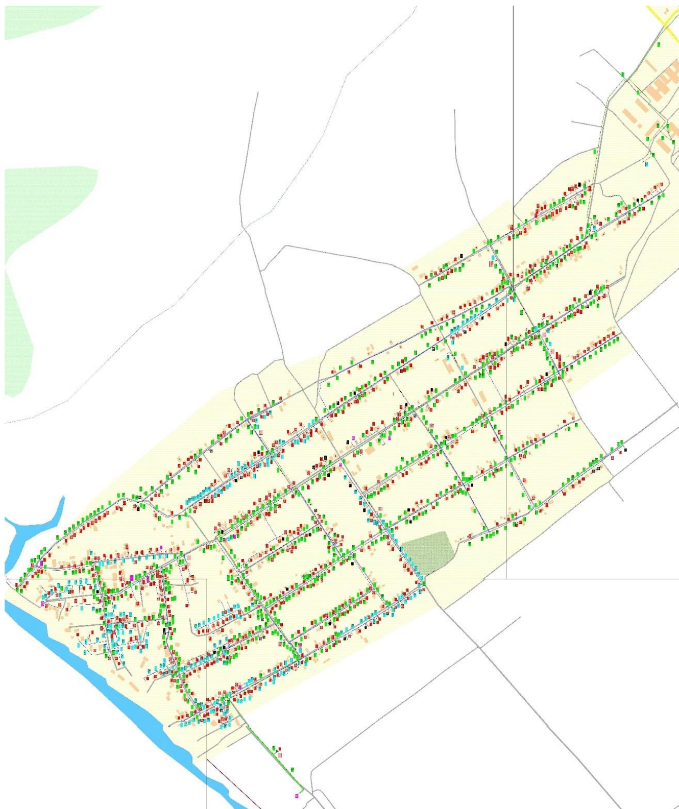
Рис. В.5. Схема гідравлічного розрахунку існуючої системи газопостачання с. Новопетрівка
