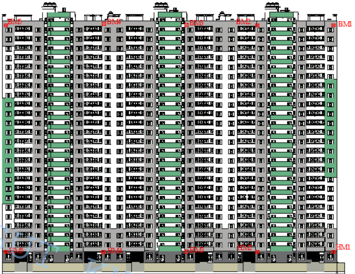
Рис. 3.18 Місця закріплення рефлекторних марок та трипелъпризм на фасаді будівлі
