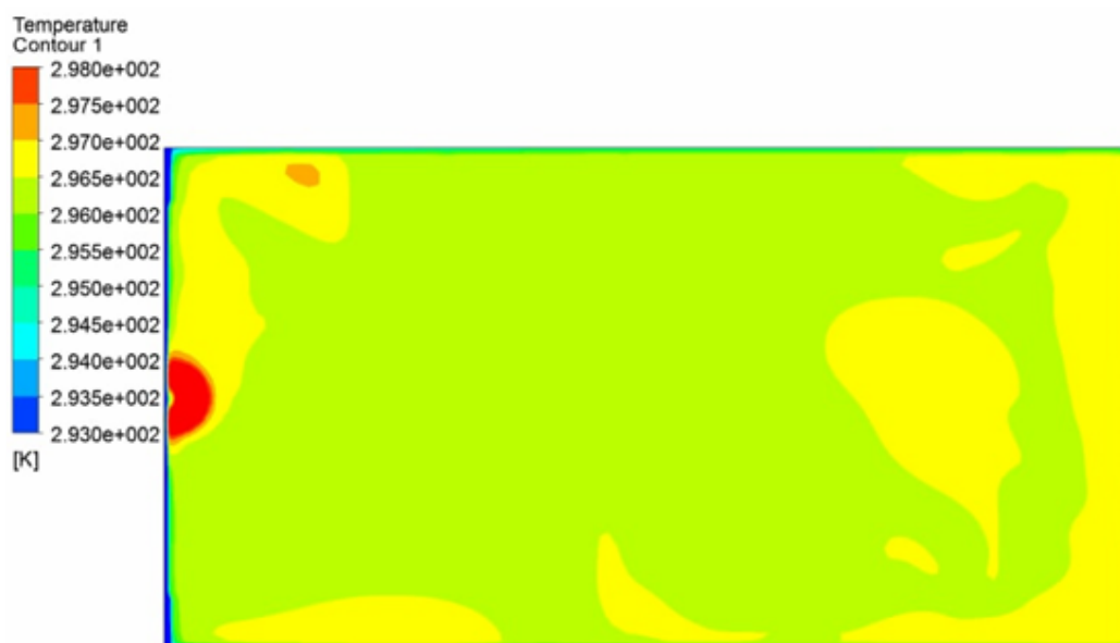
Рис. 4.10 Розподілення внутрішньої температури на горизонтальній поверхні для висоти 1,2 м
