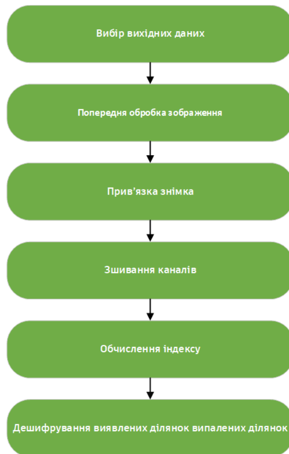
Рис. 2.3. Схема алгоритму обробки даних ДЗЗ для дослідження випалених земель
