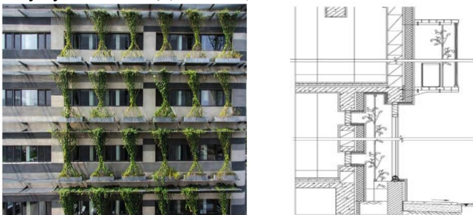
Рис.1. Система вертикального озеленення «Центр зеленого дизайну» (Тіанью (Китай) . Східний фасад і схема розрізу.
