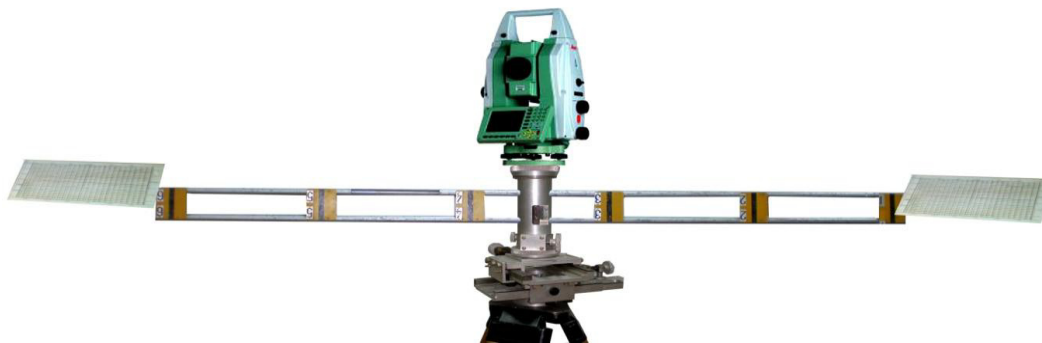
Рис.3.23. Центрувальний столик з електронним тахеометром та палетками.
