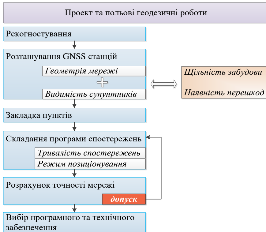
Рис. 2.28. Технологічна схема робіт на етапі проекту польових геодезичних робіт
