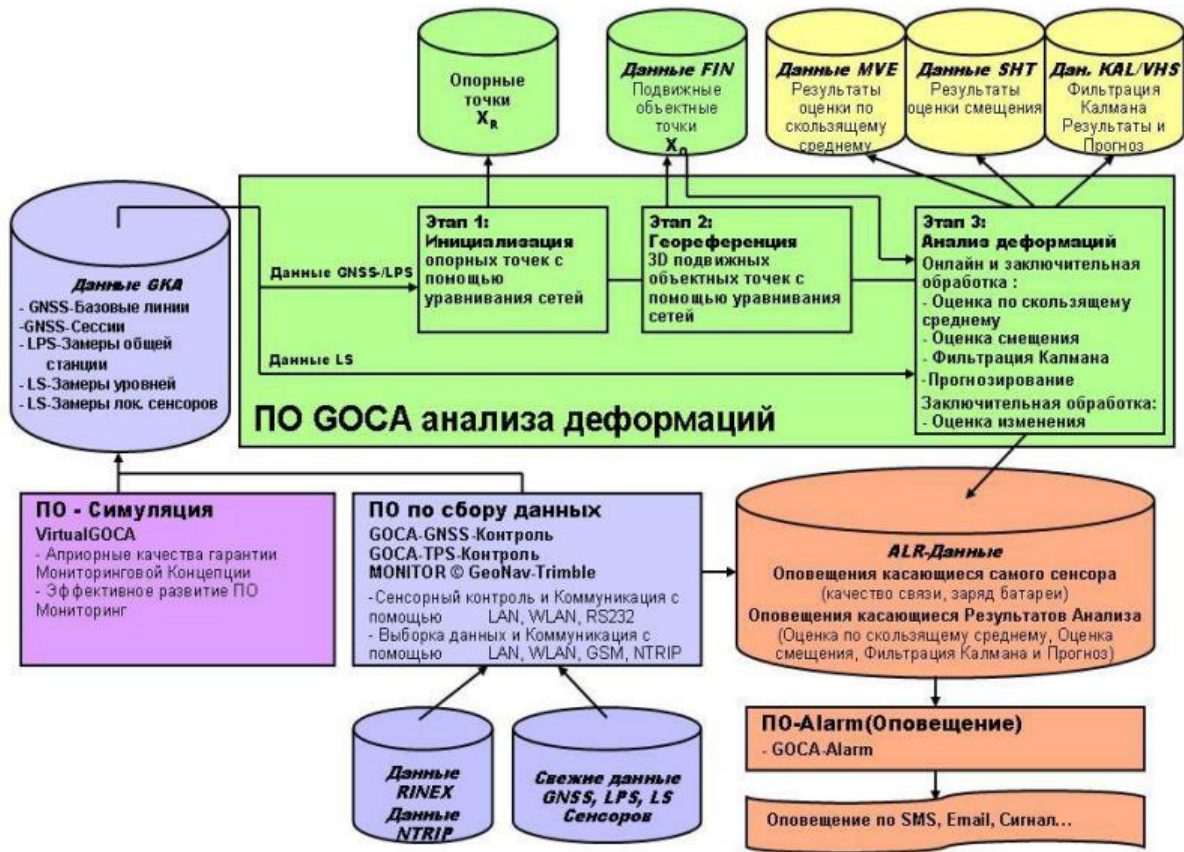
Рис. 1.20. Схема потоков данных та етапів аналізу деформацій в системі GOCA за даними сайту компанії goca.info.com
