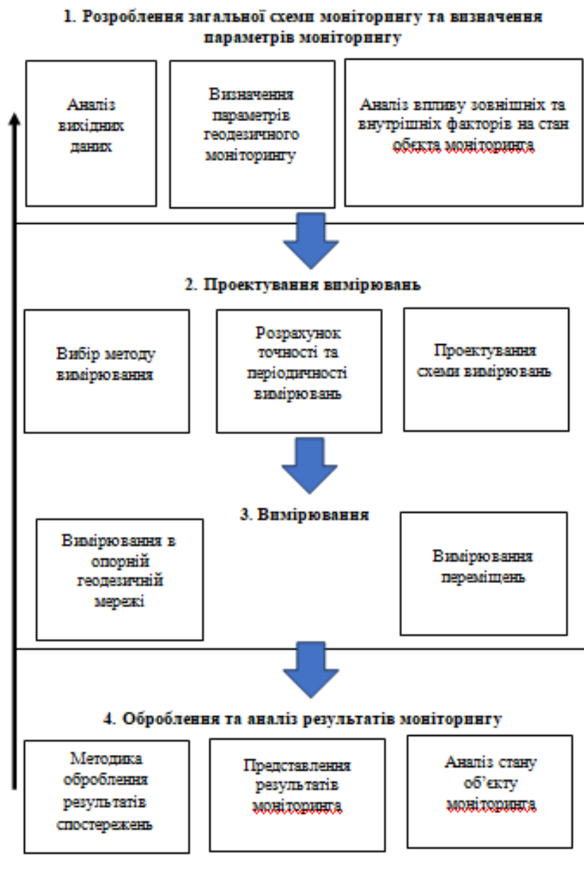
Рис. 4.6. Узагальнена технологічна схема геодезичного моніторингу
