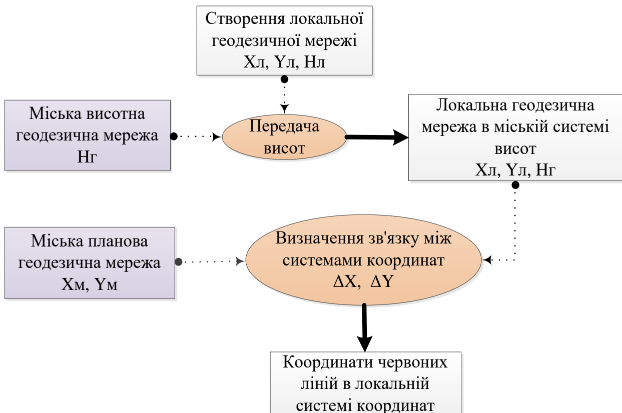
Рис. 2.6. Схема переходу до будівельної системи координат при застосуванні класичних методів в геодезії
