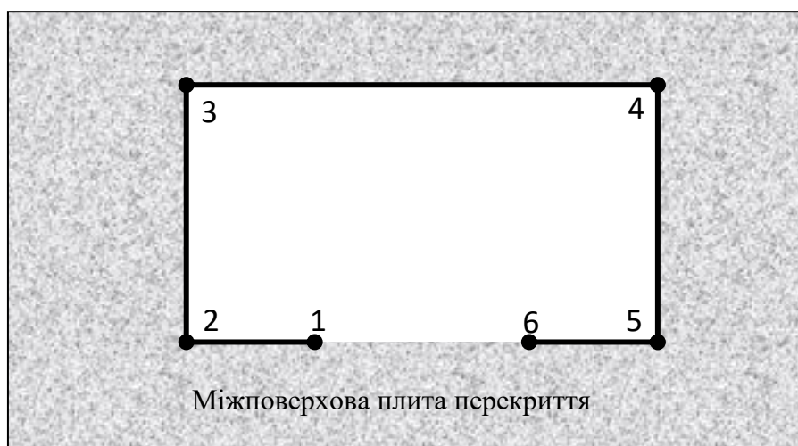
Рис.3.19 Схема розташування контрольних точок ліфтової шахти
