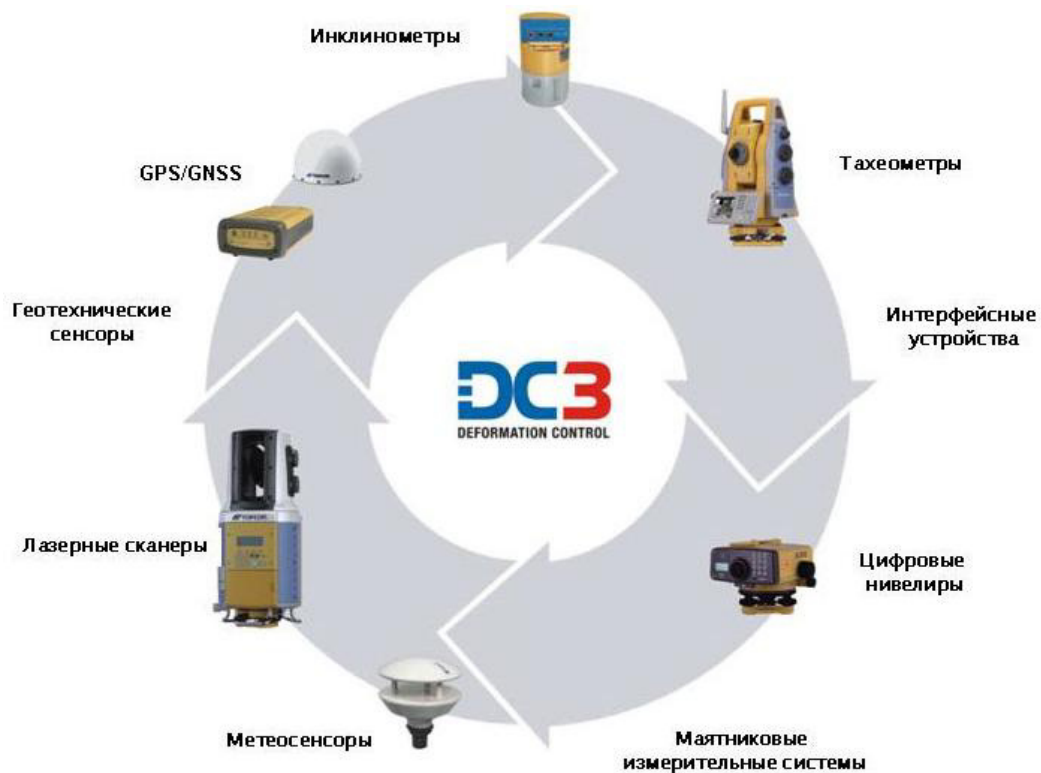
Рис. 1.18. Складові елементи системи геодезичного моніторингу DC3
