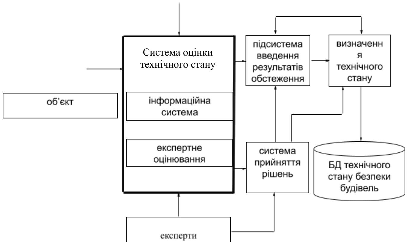
Рисунок 1.5 Технологія проведення обстеження системи діагностики технічного стану комплексної безпеки будівель
