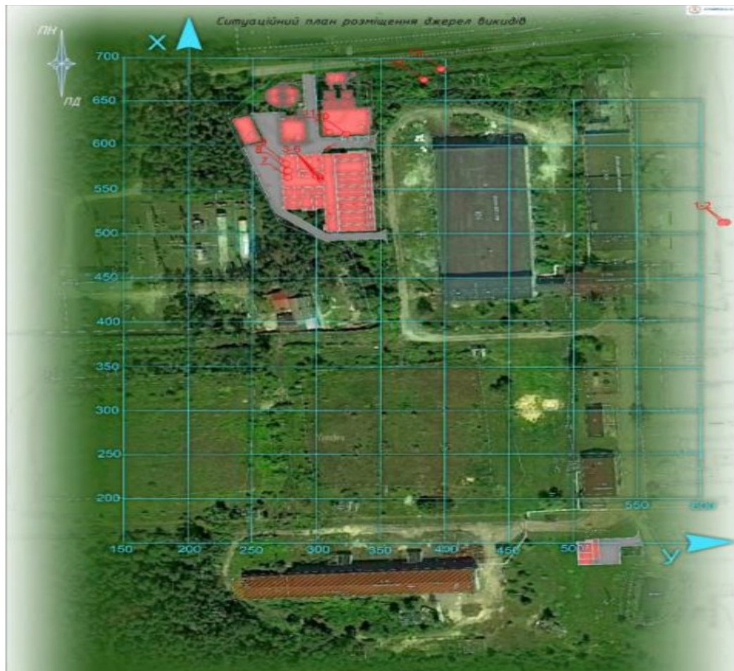
Рис.3.3. Схема району розташування ділянки досліджень 1— насосна станція першого підйому; 2 — змішувачі; 3 — реагентний цех; 4 — коловоротна камера пластівцеутворення; 5 — вертикальний відстійник; 6 — швидкі фільтри; 7 — хлораторна; 8 — резервуари чистої води;
