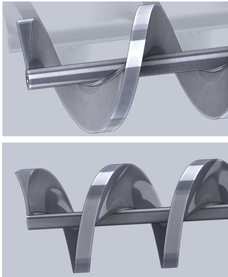
Рисунок 3.4 – 3D моделі однозахідних гвинтів складної поверхні у формі трапеції та еліптичних дуг
