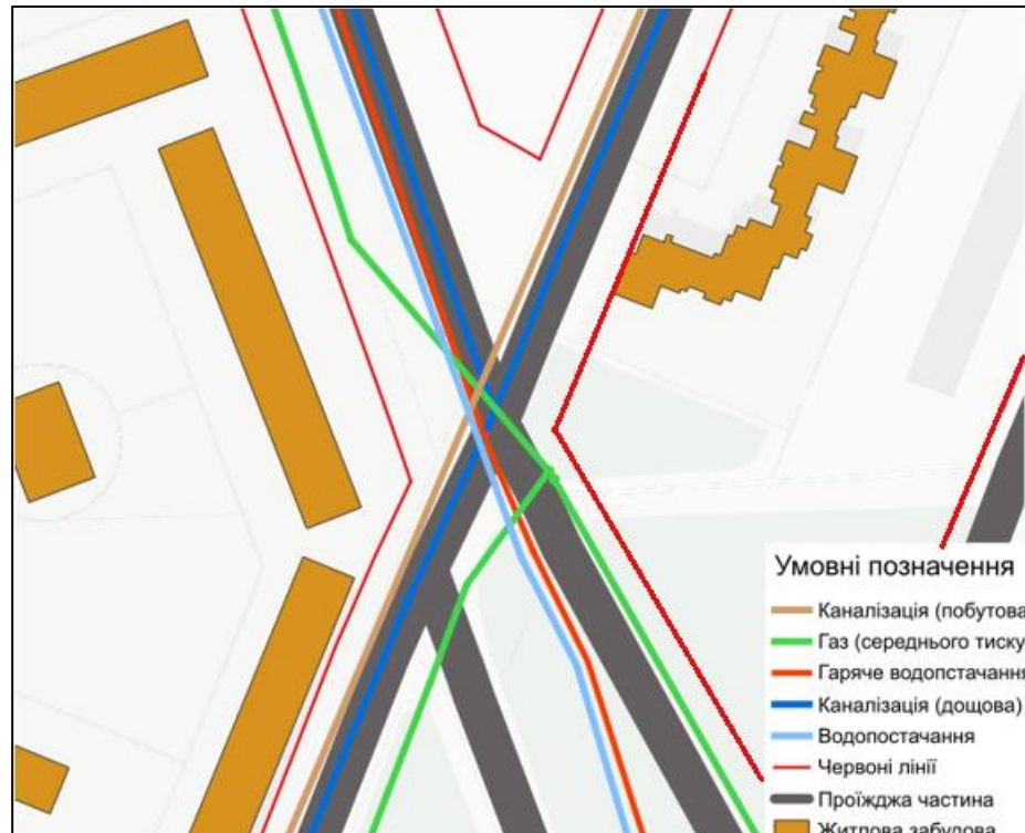
Рис. 1.6. Схема розташування інженерних мереж в межах вузла
