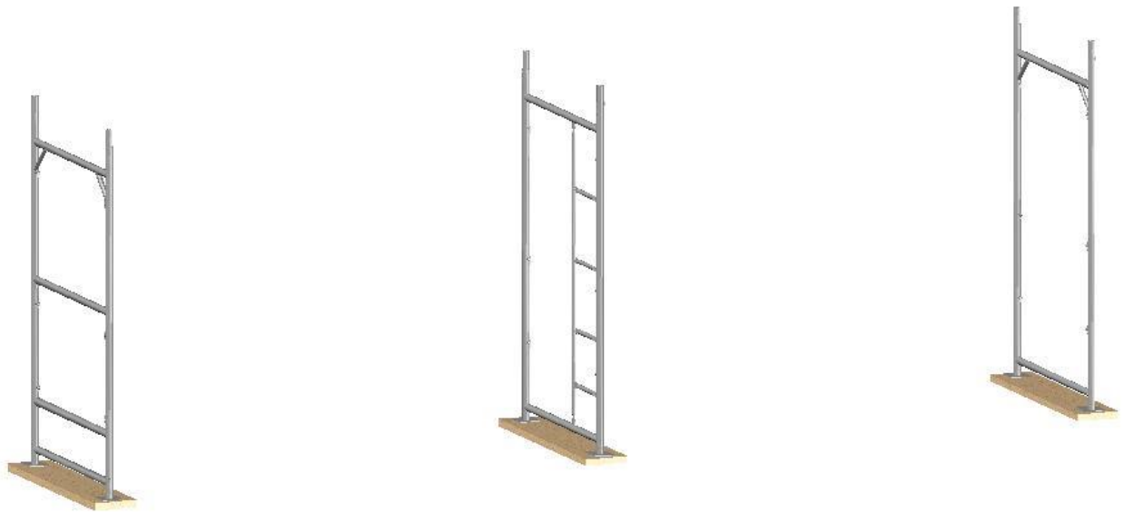
Рис. 6.1. Монтаж лесів на 1 етапі
