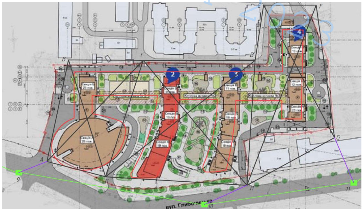
Рис 11. Схема закріплення пунктів РМБМ на генеральному плані
