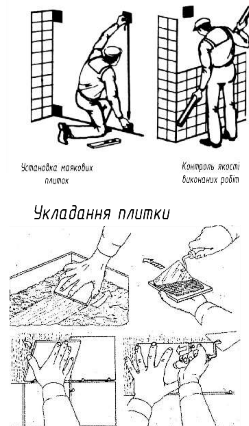
Облицювання вертикальних поверхностей
