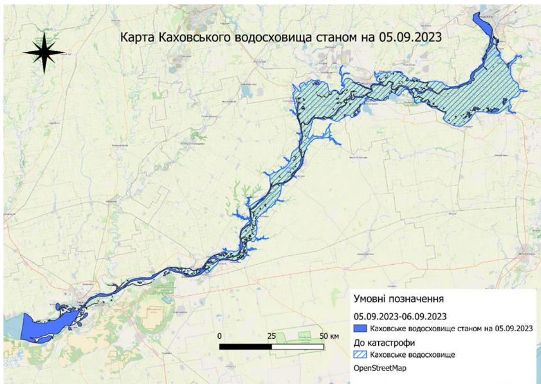
Рис. 3.7 Стан Каховського водосховища через 3 місяці після руйнування ГЕС
