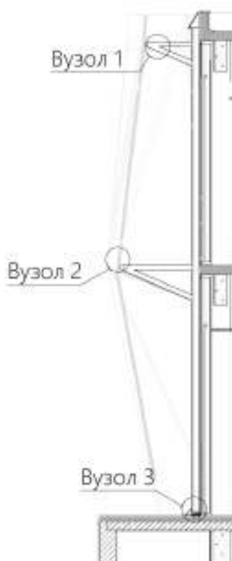
Рис. 6.2. Схема розташування вузлів кріплення системи подвійного фасаду
