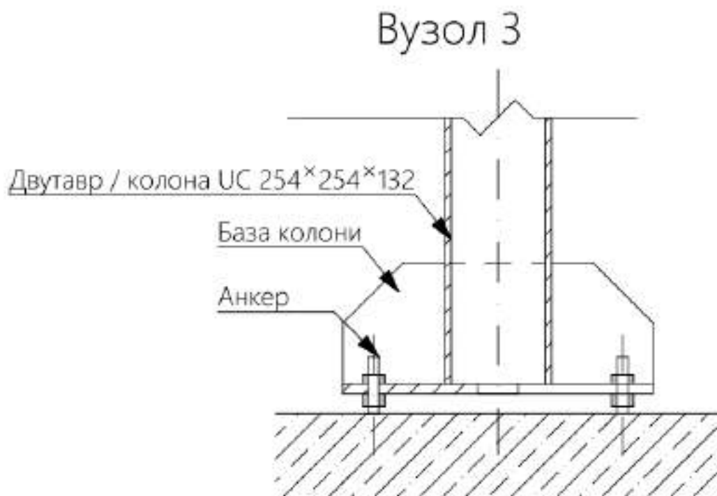
Рис. 6.5. Вузол 3. Опорний вузол сталевої колони другого фасаду
