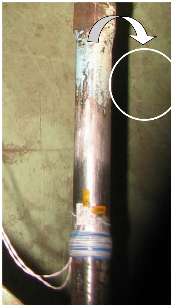
Рисунок 4. Розташування тензодатчиків на шатуні
