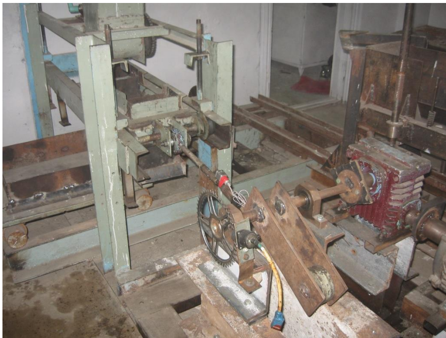
Рисунок 2. Дослідний стенд роликового формування з кривошипно-шатунним приводом
