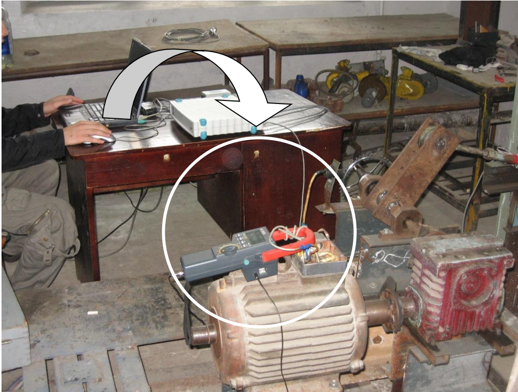
Рисунок 10. Розташування кліщів РК 435 для вимірювання потужності двигуна
