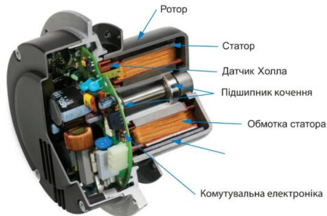
Рис.1.1. Конструкція ЕС – двигуна
