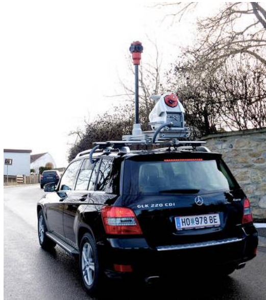
Рис 1.3 Мобільна станція закріплена на даху автотранспорту для наземного лазерного сканування.
