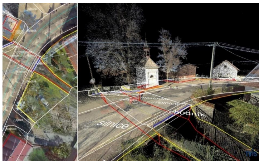
Рис. 1.15 Приклад векторизації каналу та мосту
