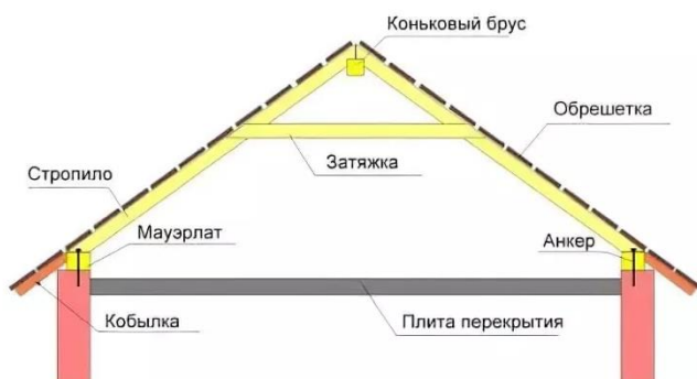
Рис.6.6. Схема двоскатної покрівлі. [28]
