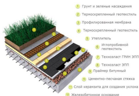
Рис.6.7. Фрагмент плоскої покрівлі [29]
