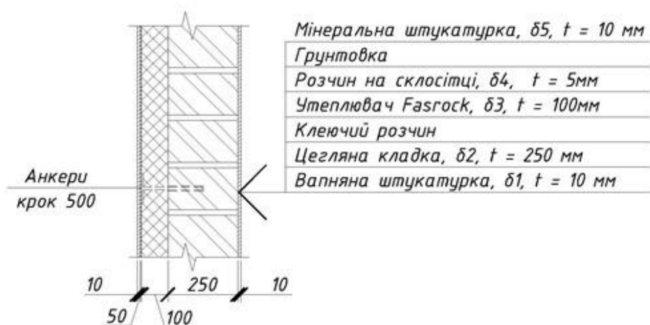
Рис. 1. Переріз стіни
