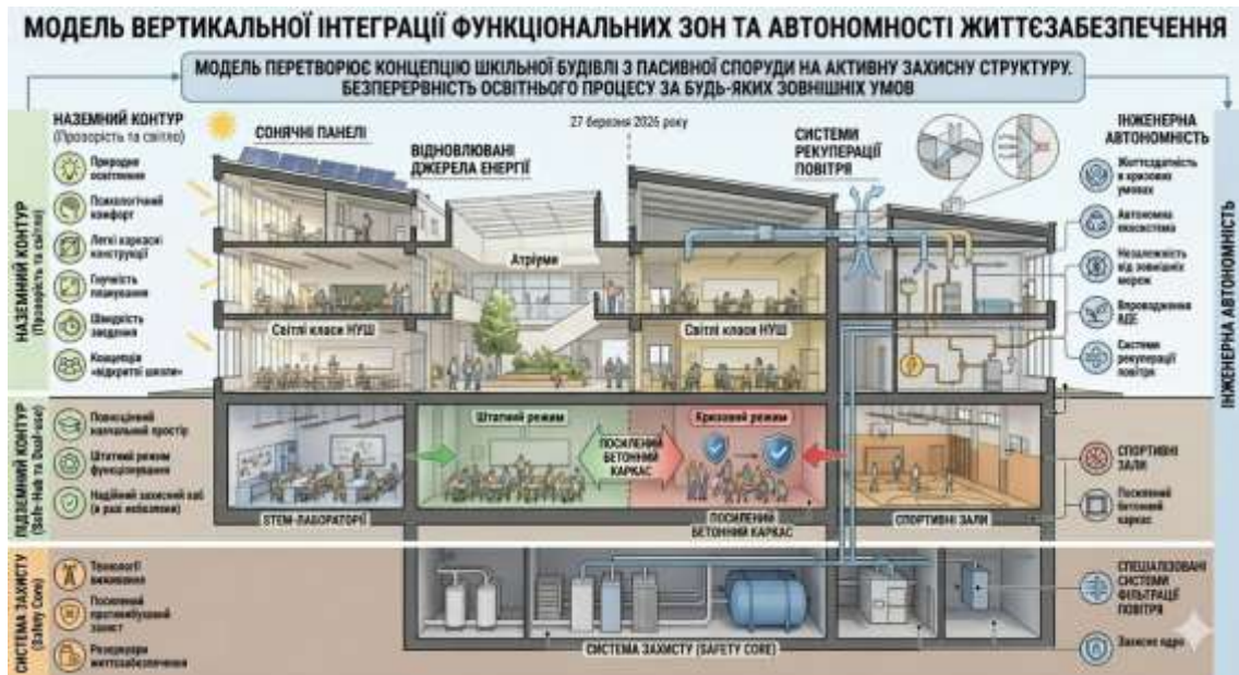
Рисунок 2.1.4. Схема-розріз Safe-Campus: Простір подвійного призначення
