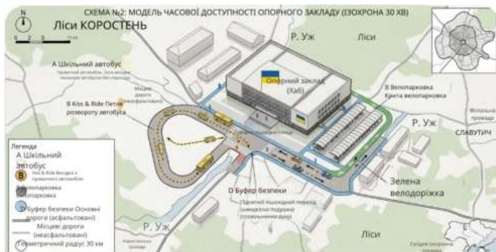
Рисунок 2.2.2. Просторове розмежування транспортно-пішохідних потоків біля входу в Опорний заклад (вузол «Школа–Транспорт»).
