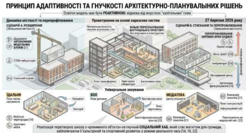
Рисунок 2.3.4. Принцип адаптивності та гнучкості архітектурно-планувальних рішень
