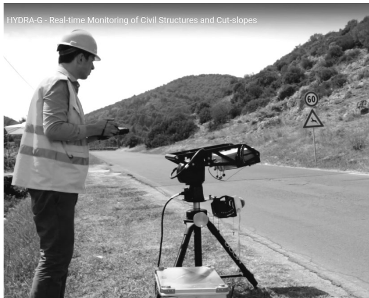
Рис. 13. Радіолокаторне сканування зсувного схилу портативним радаром IDS HYDRA-G
