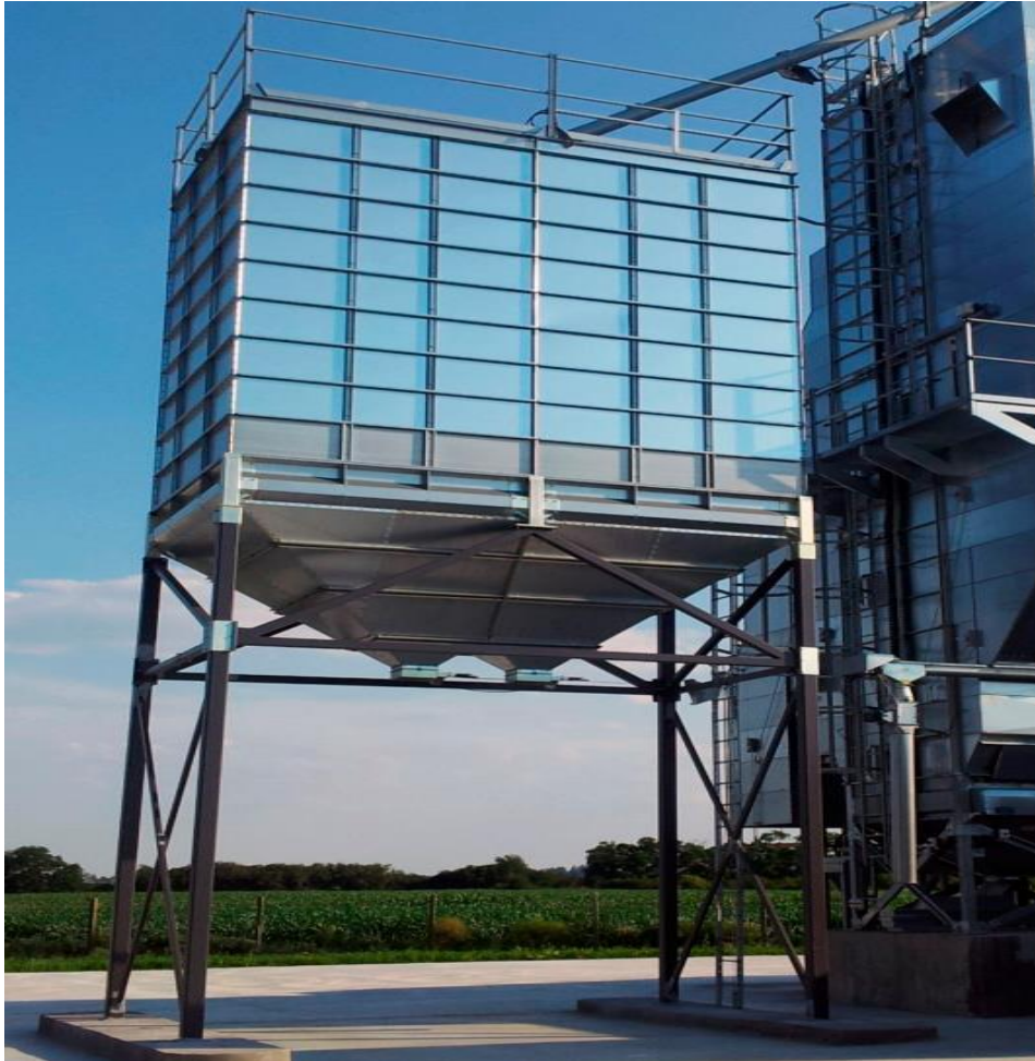
Рисунок 1 – типова конструкція бункера для зберігання та подачі будівельних сумішей
