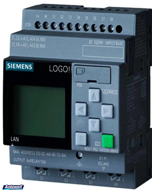
Рисунок 3.3– контролер Siemens LOGO! 8 Технічні можливості LOGO! 8
