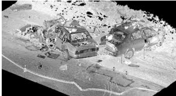
Рис. 3. Результат сканування місця ДТП на трасі Харків — Сімферополь у вигляді 3D-зображення
