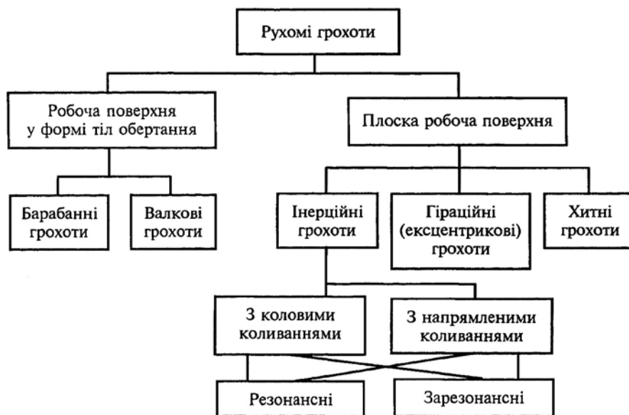
Рис.1.2. Класифікація рухомих грохотів в залежності від робочої поверхні та режиму роботи.
