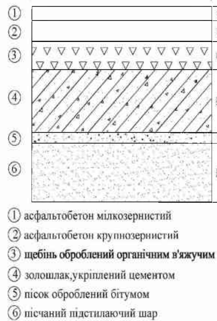
Конструкція дорожнього одягу ВДМ
