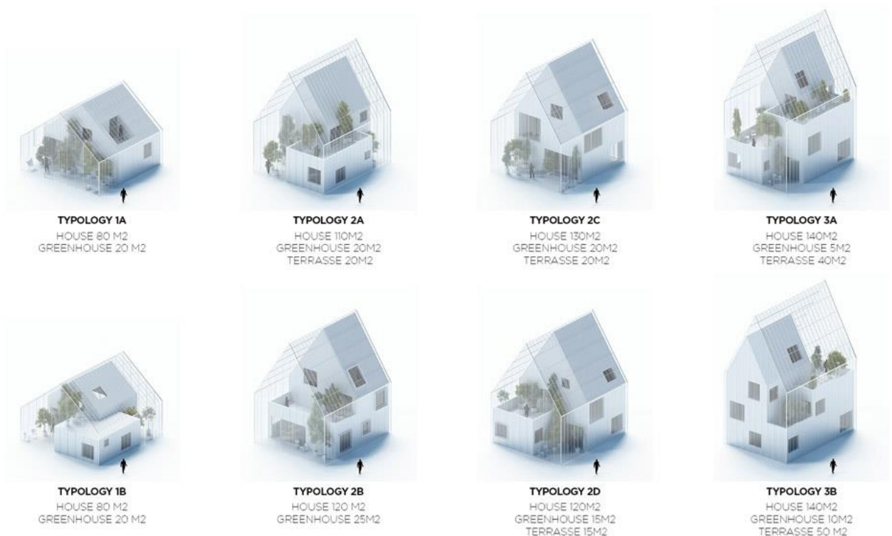
Рис. 2.2.2. Варіанти розташування теплиць в житловому будинку Концепція енергоефективних будинків автономного екопоселення ReGen Villages у Голландії [47].
