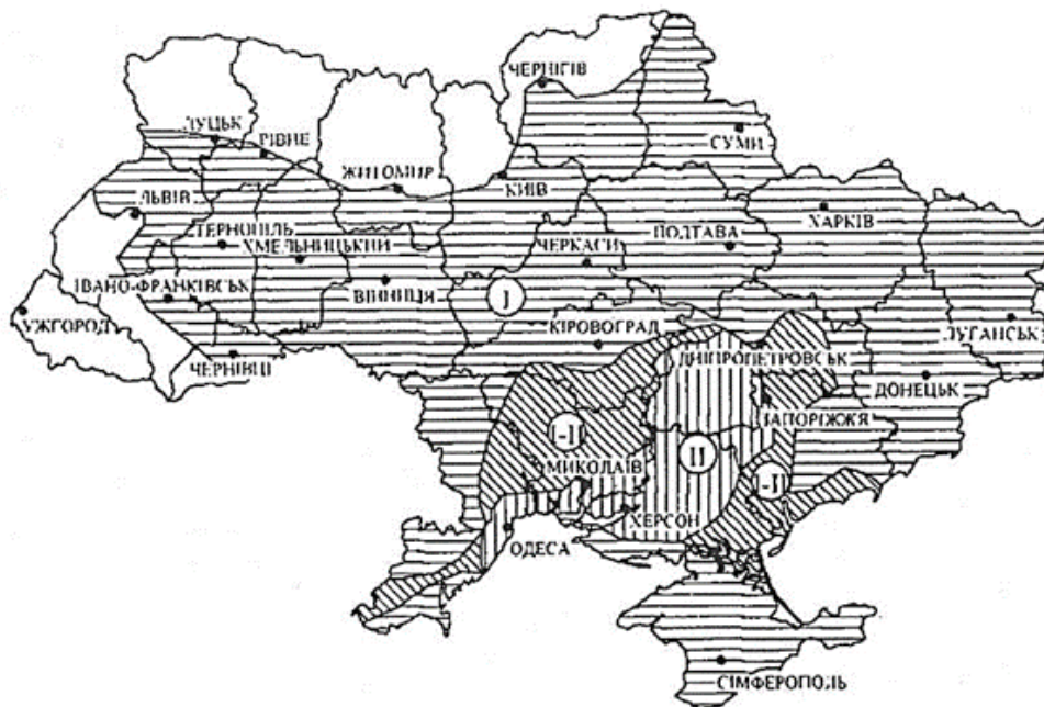
Рис. 79. Карта лесових ґрунтів в Україні: I – перший тип; II – другий тип просідання
