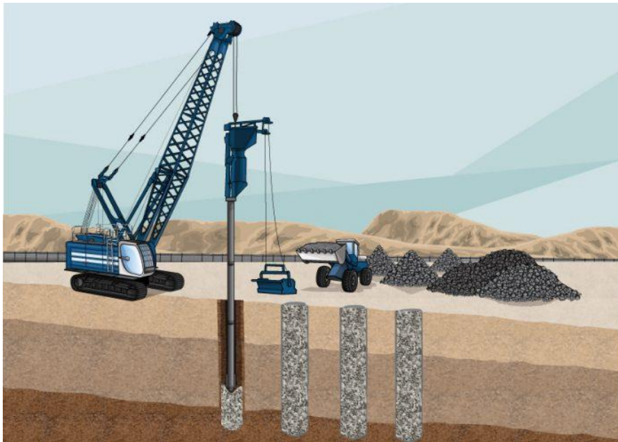
Рис. 69. Комплект машин для влаштування піщаних паль-дрен
