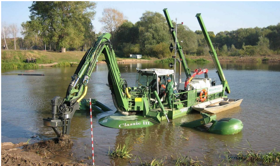
Рис. 93. Плавзасіб із серійним обладнанням для розчищення русла річок
