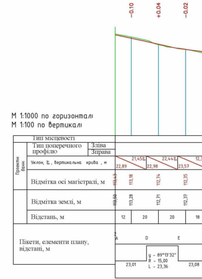
Поздовжній профіль магістралі районного значення 0-3 (вул. Автозаводська)
