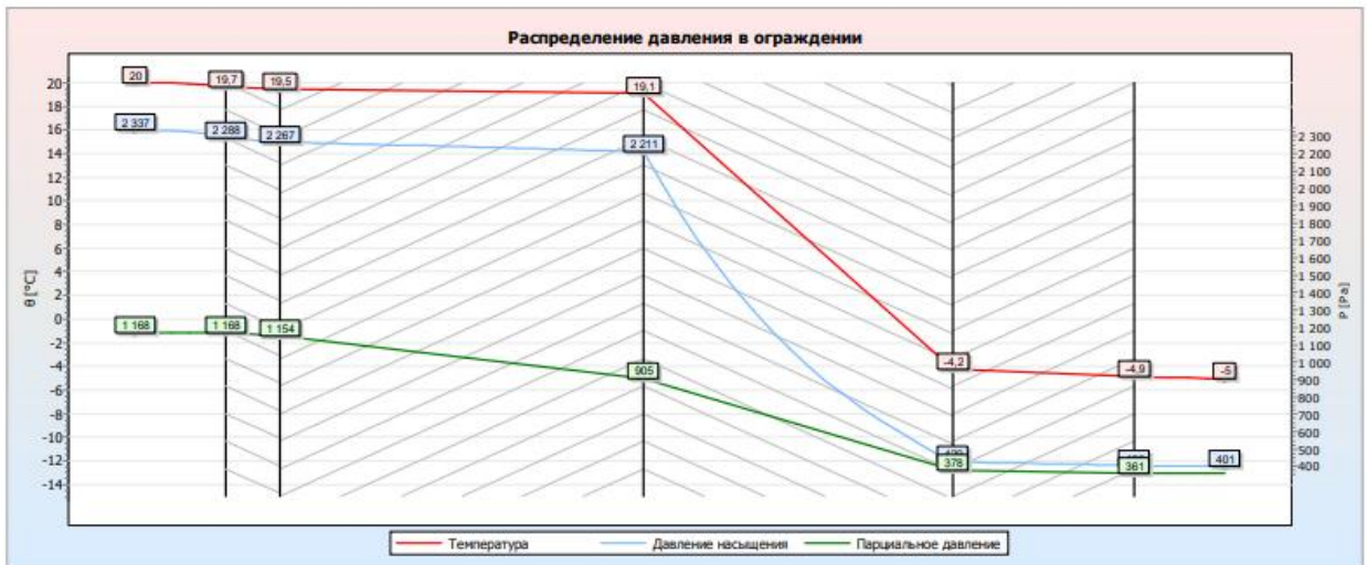
Рис.1.4. Розподіл парціальних тисків при середн.зовн. темпер.в суміщ.пер.
