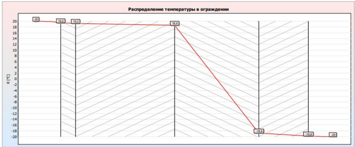
Рис.1.3. Розподіл температур в конструкції суміщеного покриття.
