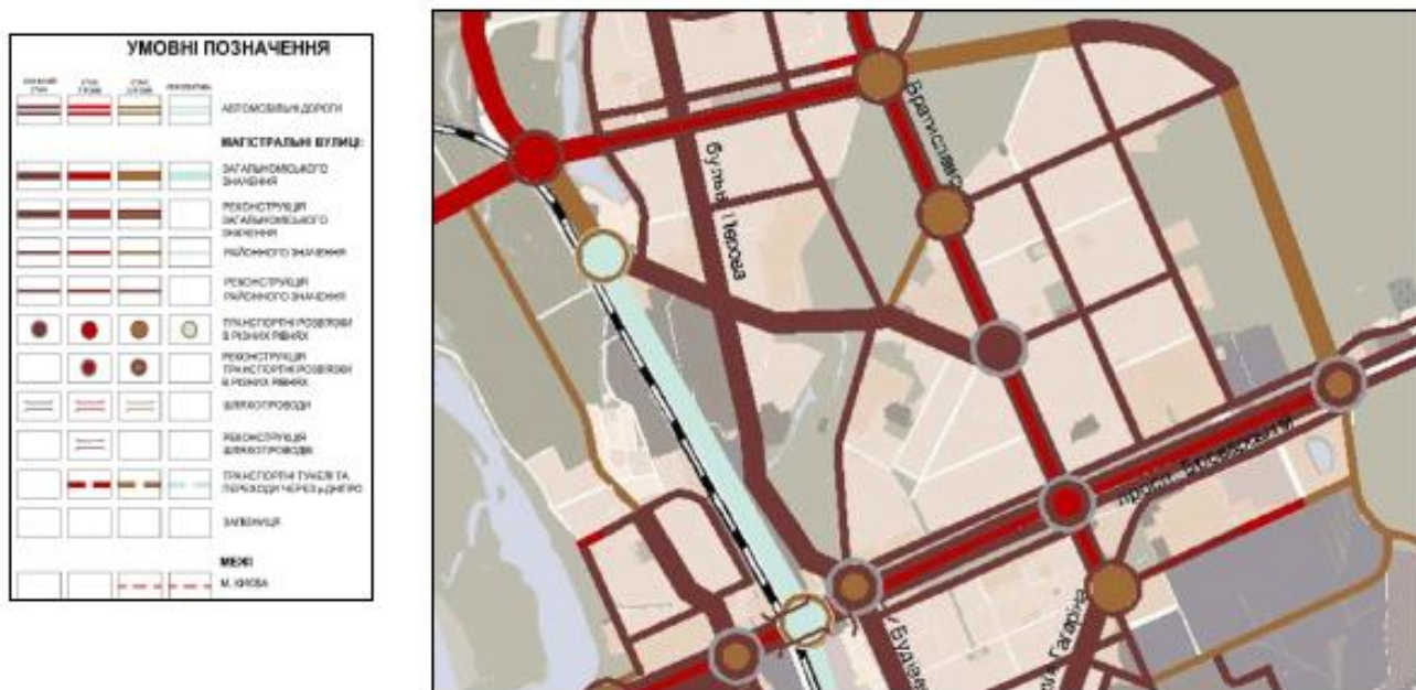
Рис.4.2 Будівництво нових магістральних вулиць біля Північно-Броварського масиву
