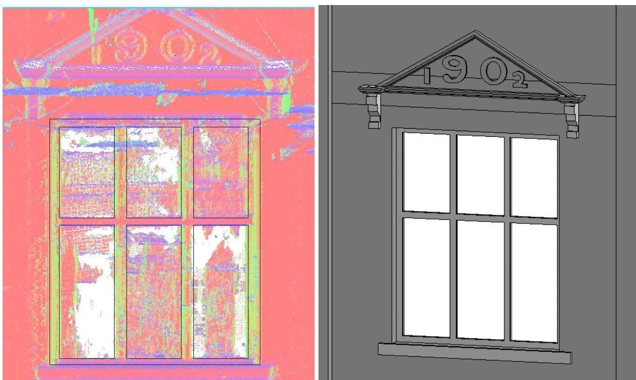
Рис. 3.3.3.1. Моделювання вікна та підвіконня по хмарі точок ( а – хмара точок, б – модель на основі хмари)
