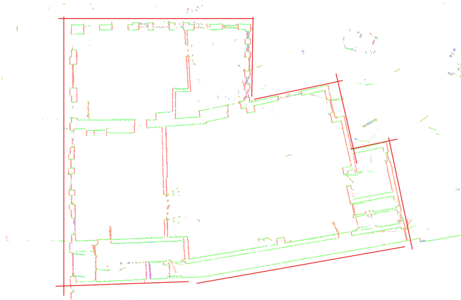
Рис. 3.3.1.6. моделювання зовнішніх стін будівлі
