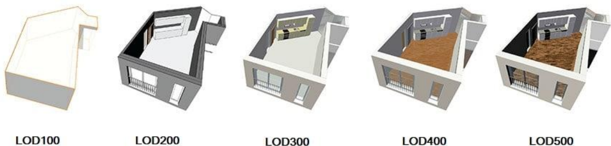
Рис. 1.3.1.1. Приклад рівнів LOD на відображенні плану кімнати
