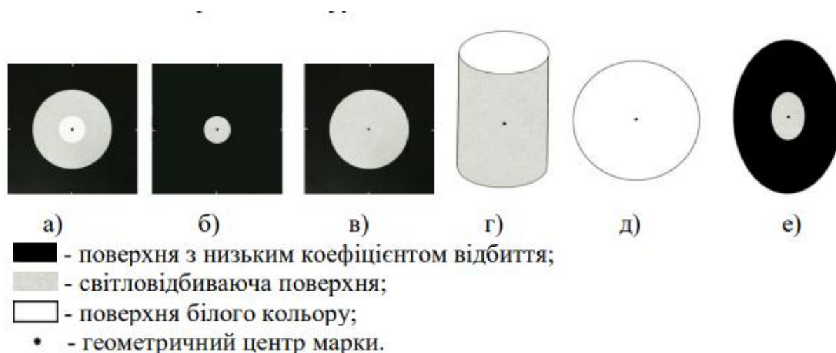
Рис. 2.2.5.1 Типи сканерних марок
