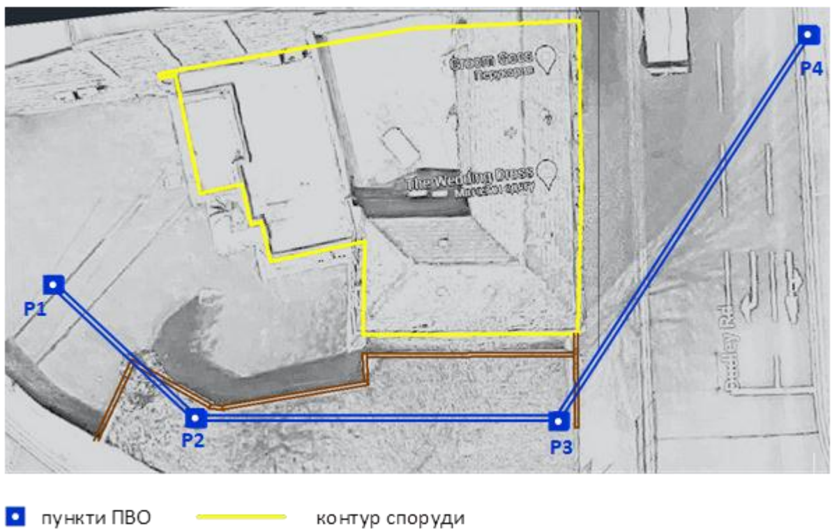
Рис. 2.2.5.4. Схема розташування вихідних базисів
