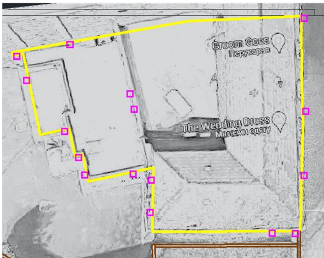
Рис. 2.2.5.5. Схема розташування плоских марок
