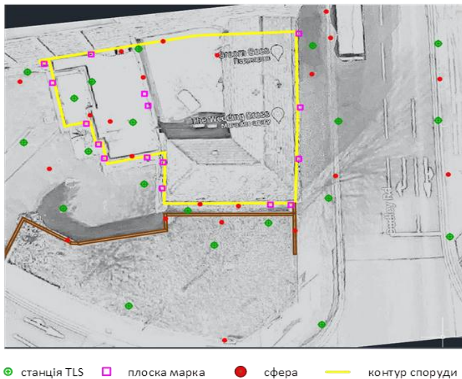
Рис. 2.2.5.7. Схема розташування об'ємних марок, станцій сканування та плоских марок
