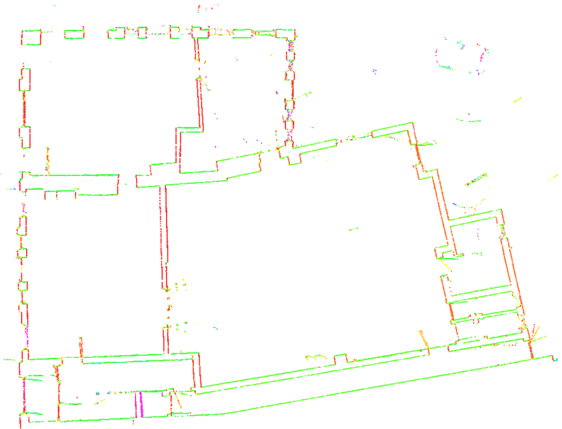
Рис. 3.3.1.5. Зріз хмари точок на рівні 1,5 метри
