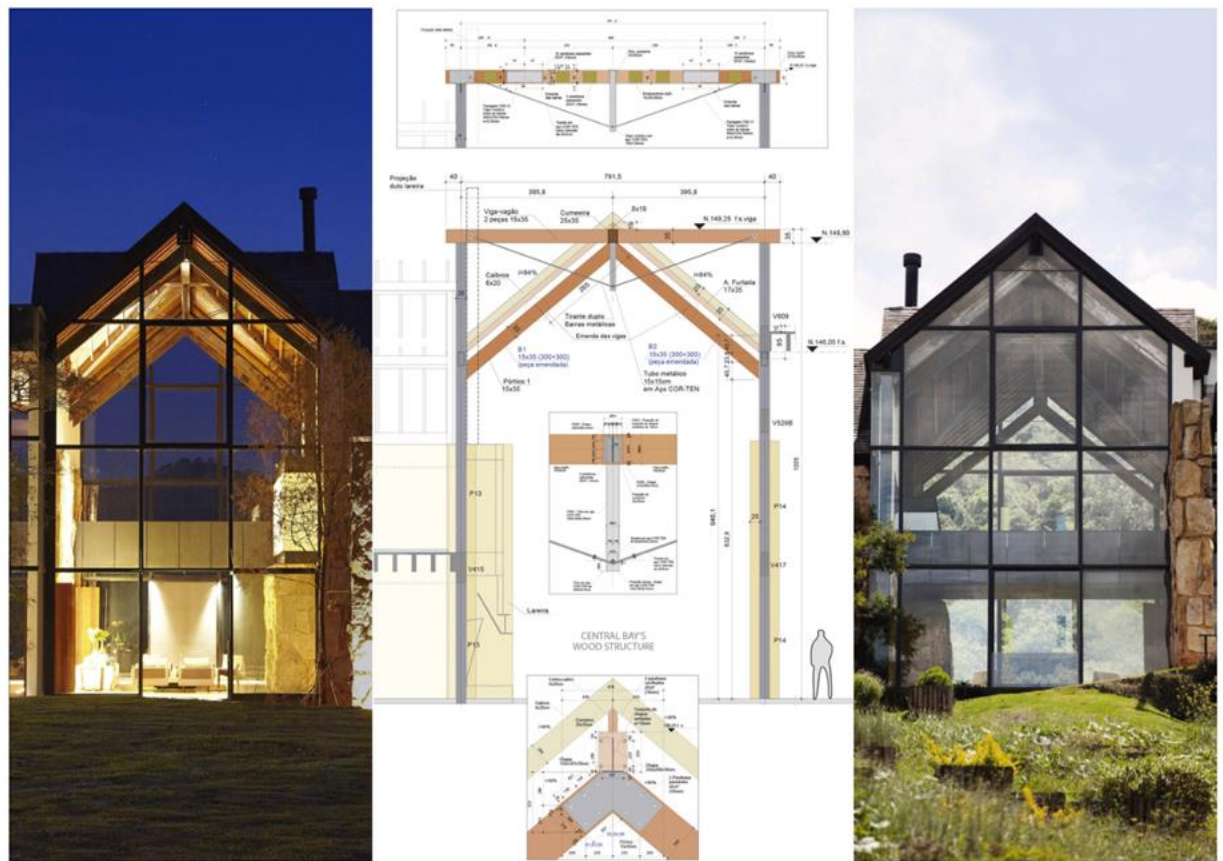
Рис. 2.7. Зовнішній вигляд та конструктивний розріз будівлі [3]
