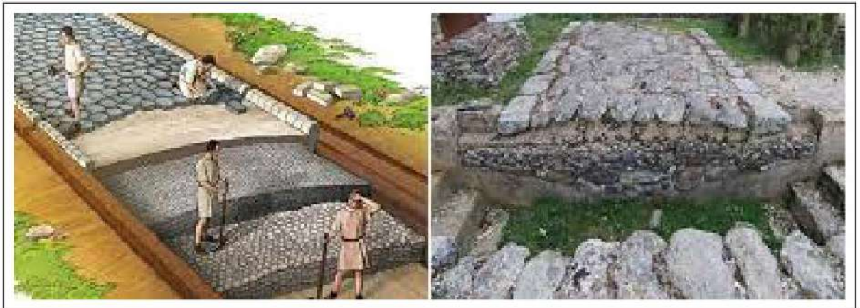
Рис. 1.2. Технологія укладання дороги часів Римської імперії [110].
