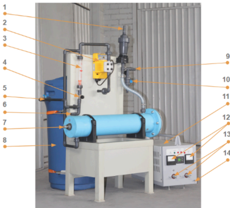
Зовнішній вигляд установки знезараження води «Полум'я-2» продуктивністю 10 кг активного хлору за добу.
