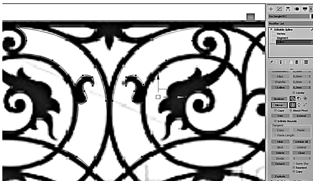
Рис. 48. Дзеркальне відображення контуру за допомогою команди Mirror відносно вертикальної осі симетрії
