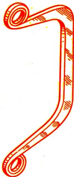
Рис.1. Загальний вигляд пластинчастої ресори Fig.1. General view of the lamellar spring
