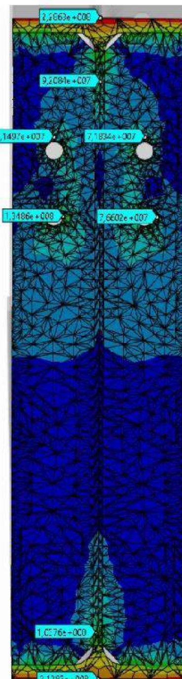
Еквівалентні напруження на рівні середини балки в ПК ANSYS
