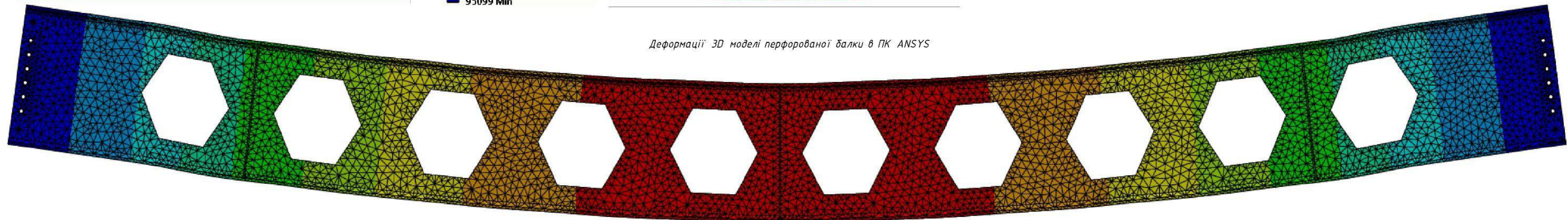
Еквівалентні напруження 3D моделі перфорованої балки в ПК ANSYS
