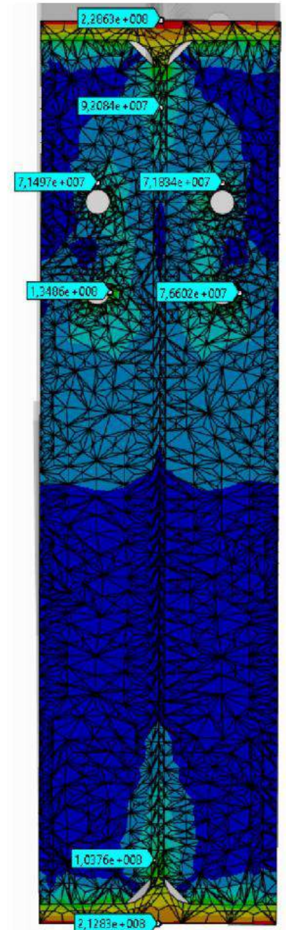
Еквівалентні напруження на рівні середини балки в ПК ANSYS
