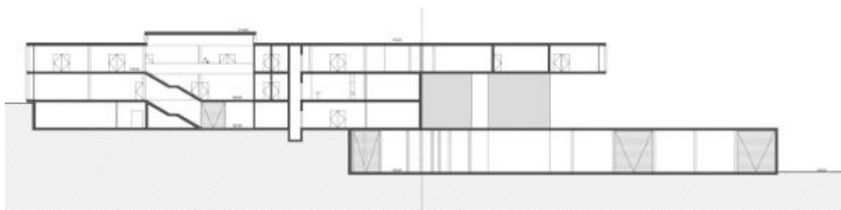
Рис.2.33 Розріз будівлі офісного центру [57]
