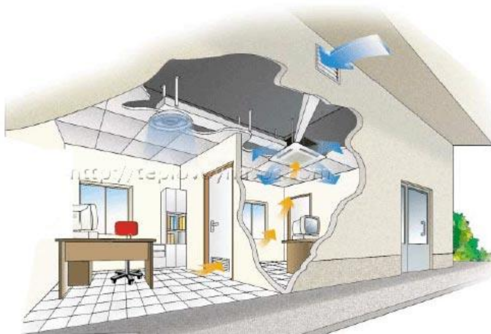
Рис. 7.2.1 Система опалення, що працює на нагрітому повітрі [41]
