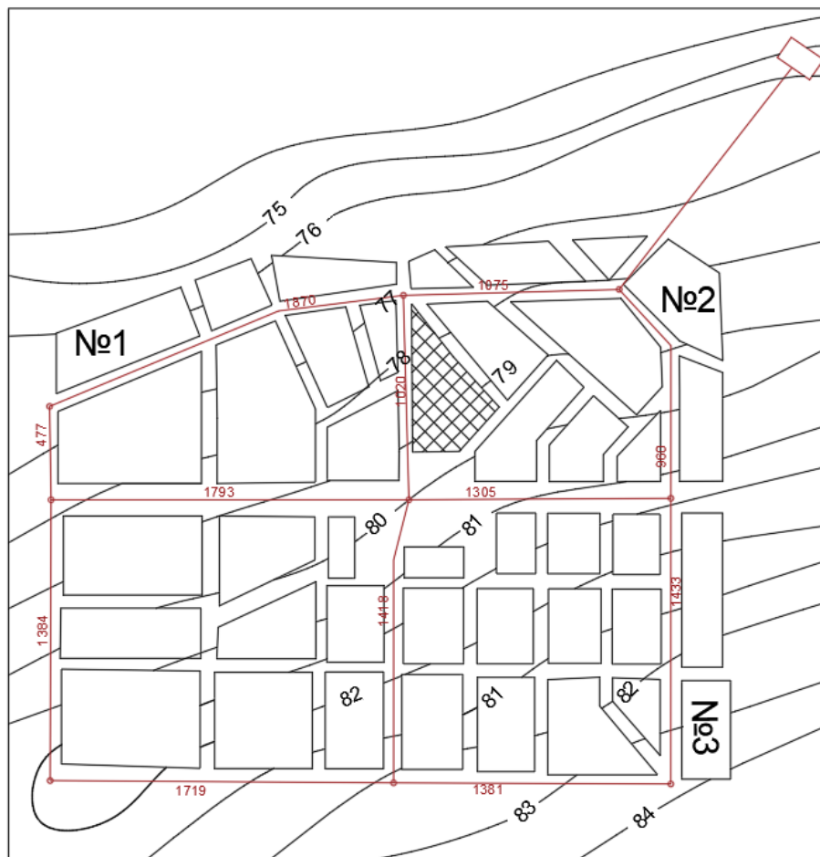
Рис.4. Траса магістральної водопровідної мережі і водоводів
