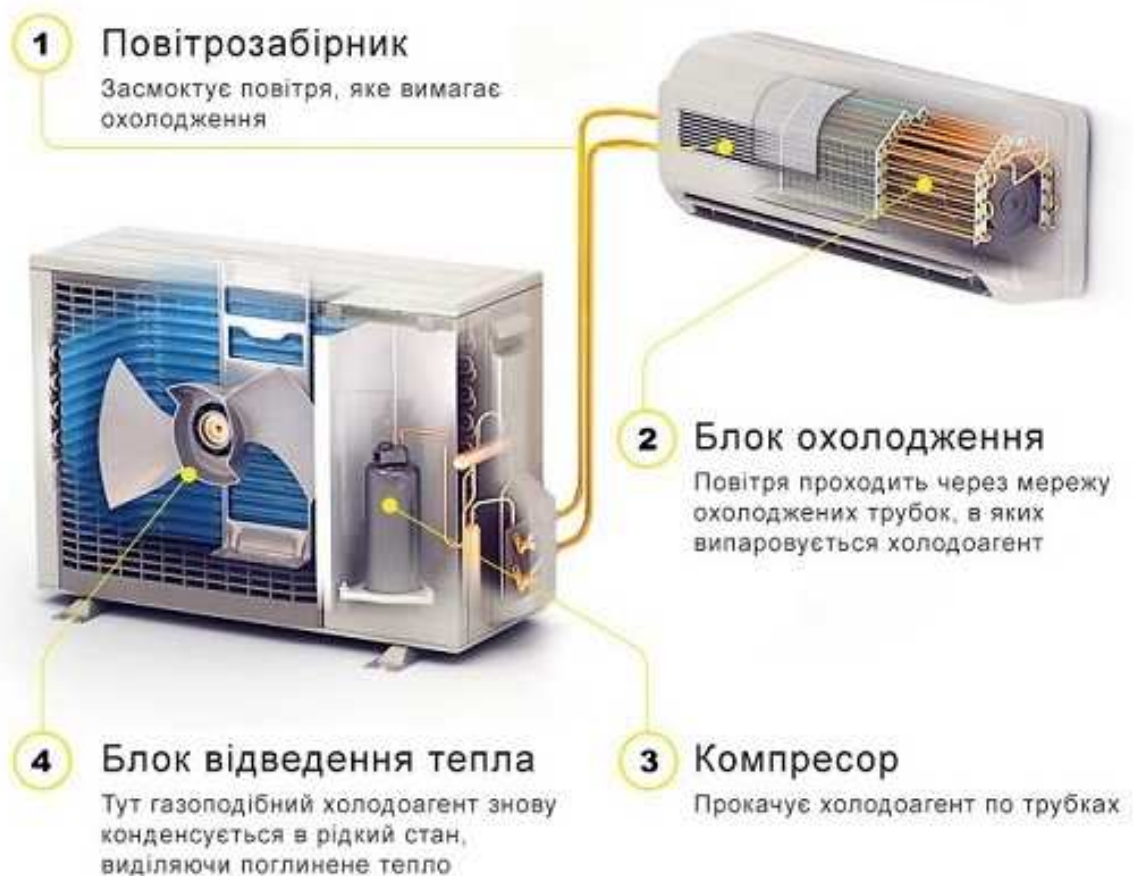
Рис. 2.5 Принцип функціонування спліт-системи
