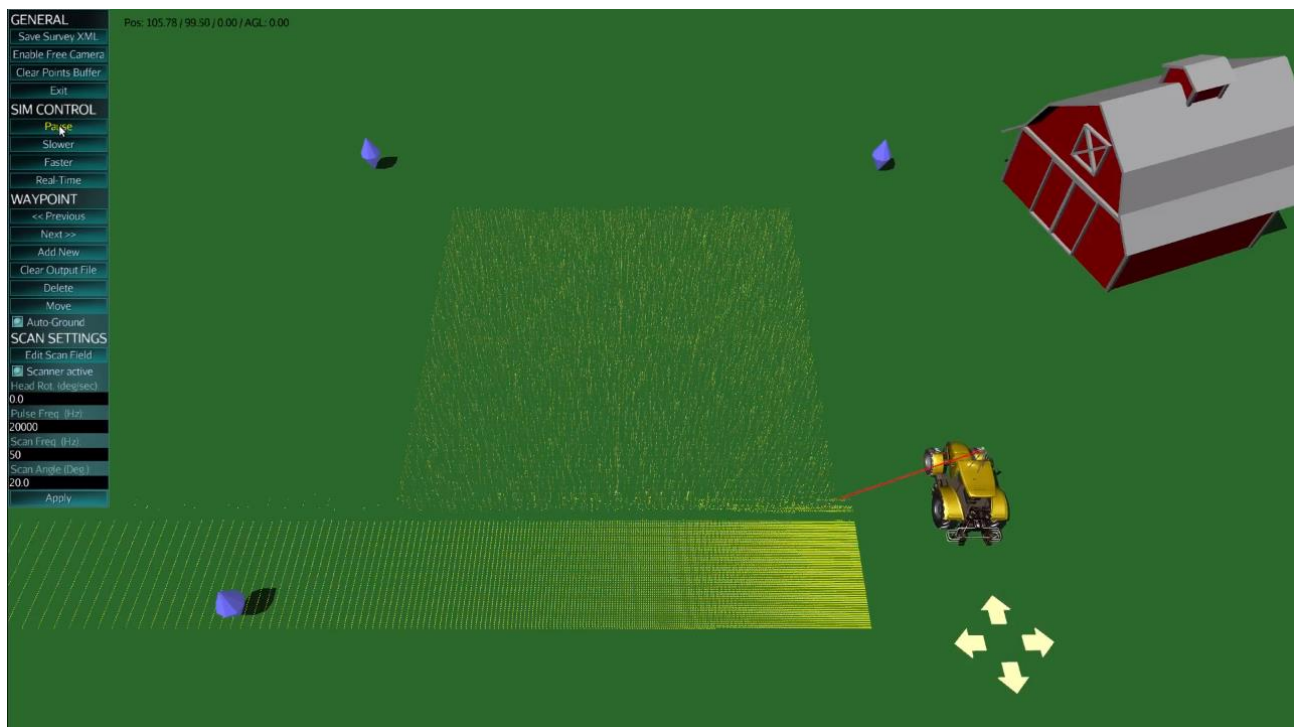
Рис.2.13. Лазерний симулятор HELIOS
