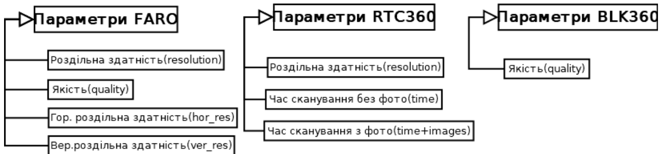
Рис.2.8. UML-діаграма параметрів управління
