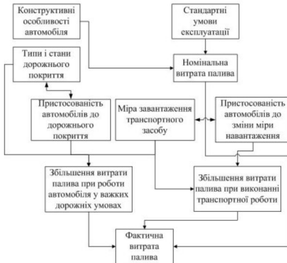
Рис. 2.1 Механізм формування витрати палива автомобілів з різним завантаженням в залежності від типу і стану дорожнього покриття
