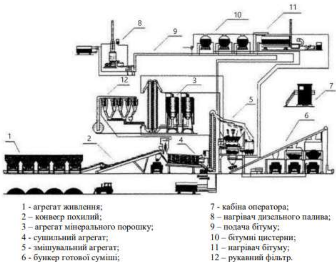
Рис 3.2 – Технологічна схема роботи асфальтозмішувальної установки ДС-168
