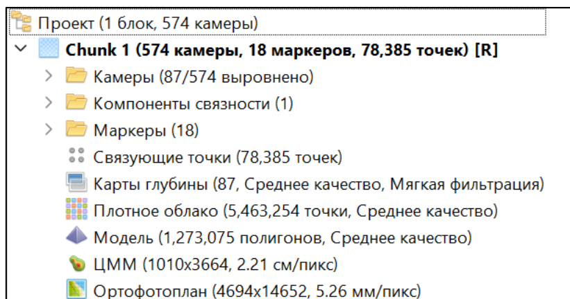
Рис 3.4.4.3. Результати обробки зображень з п'ятьма перекриттями.
