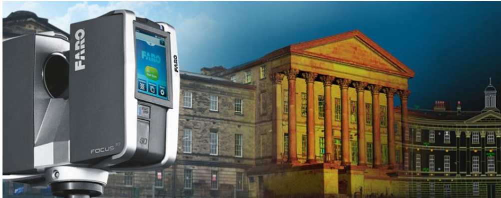
Рис1.2.1. 3D сканування фасаду (ЛАЗЕРНЕ СКАНУВАННЯ)
