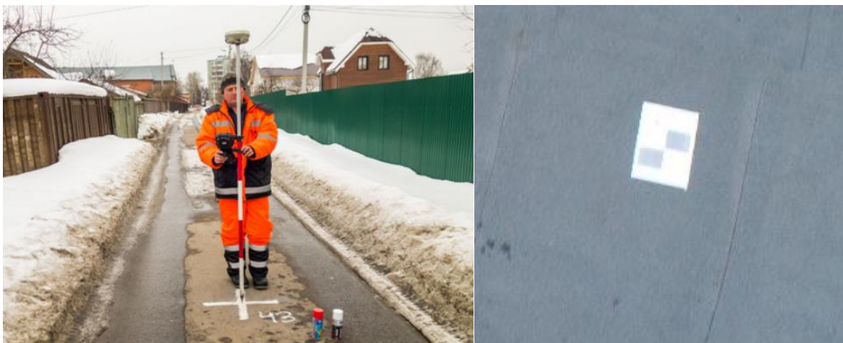
Рис 2.1.2 Розставлення розпізнавальних знаків на місцевості за допомогою геодезичного GNSS приймача
