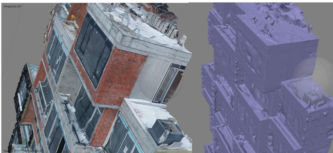
Рис 3.4.4.6. Модел отримана з чотирма перекриттями.
