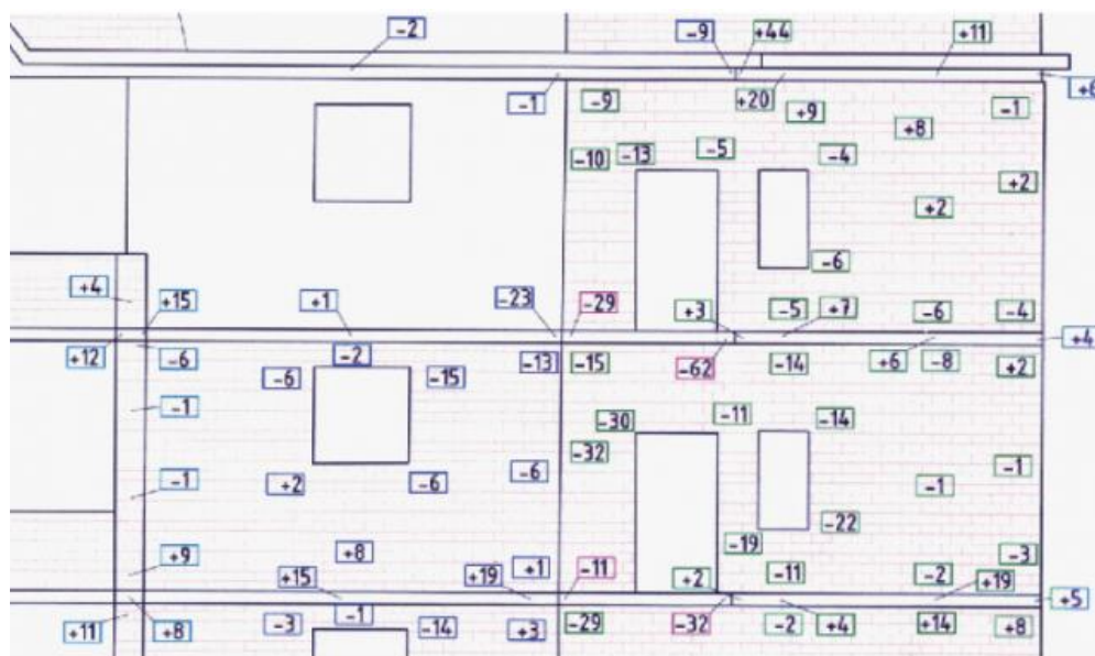
Рис. 1.4.2.1. Фрагмент розгорнення фасаду з відхиленнями від вертикалі цегляної кладки та бортів перекриттів
