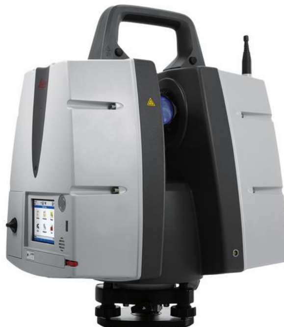
Рис.1.4.3.4. Приклад фазового сканера
