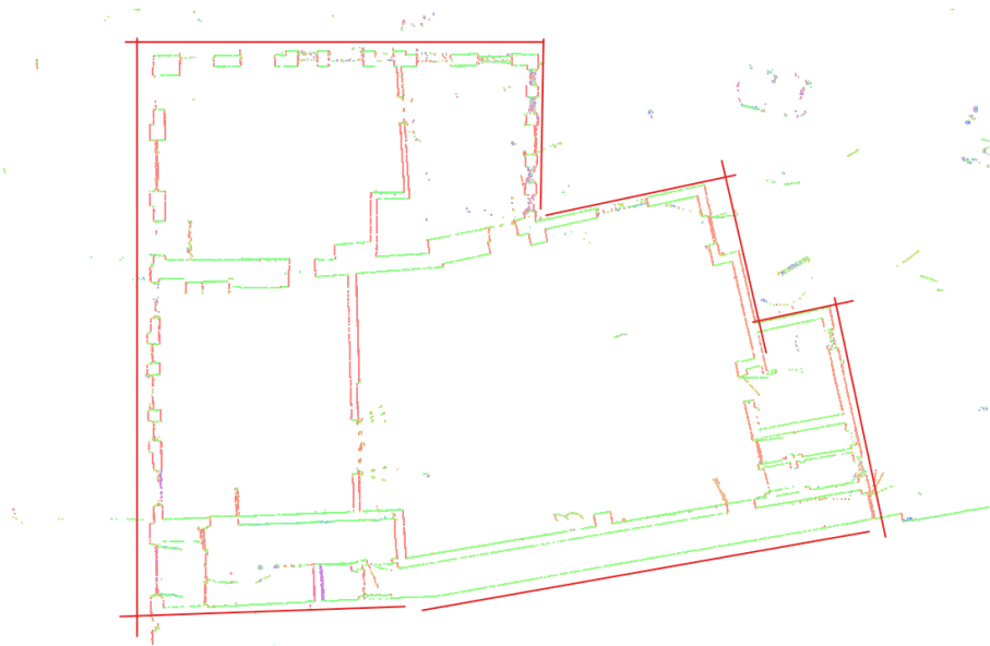
Рис. 3.3.1.6. моделювання зовнішніх стін будівлі
