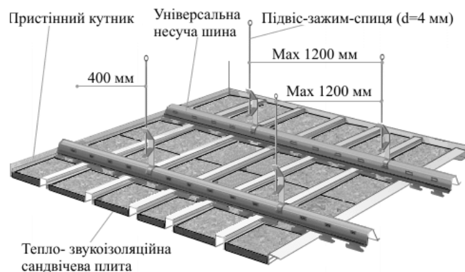
Рис. 5. Конструктивна схема підвісної тепло-звукоізоляційної стелі
