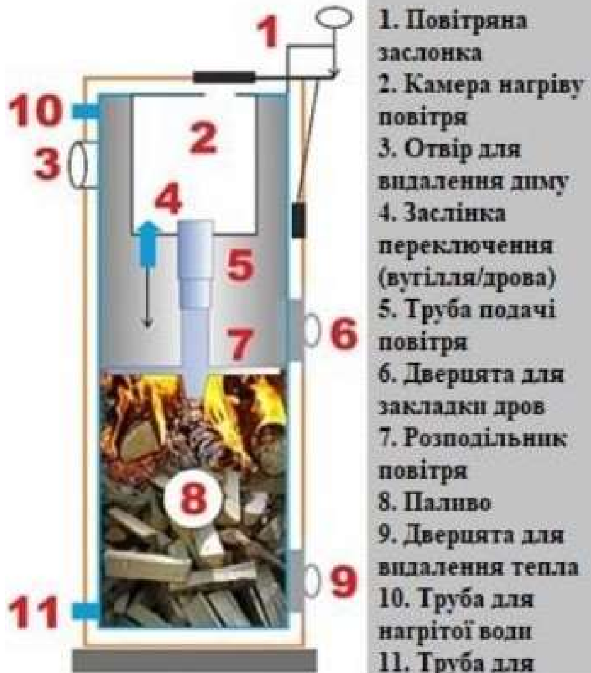
Рисунок 2.2 – Класична схема твердопаливного котлу тривалого горіння
