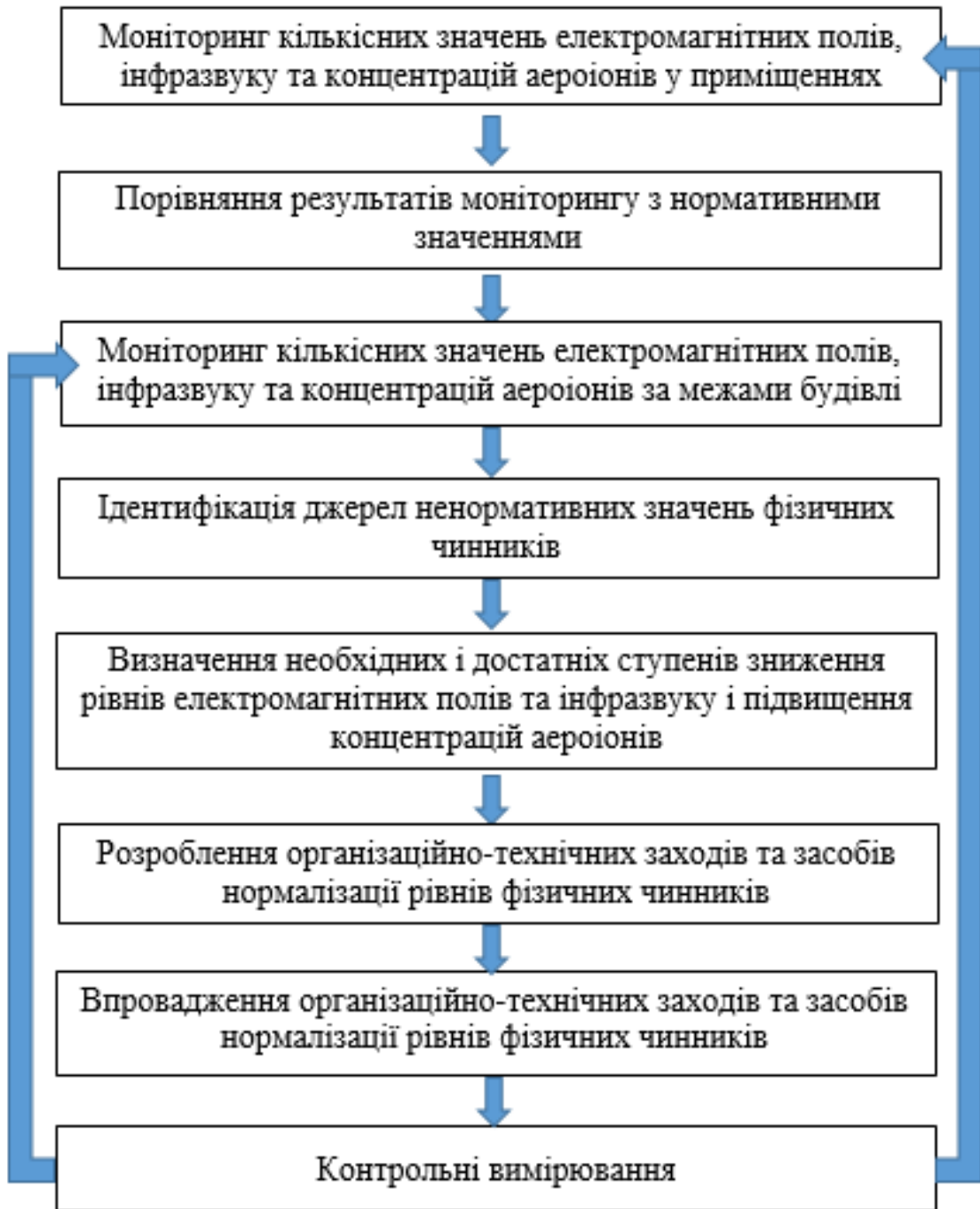
Рисунок 19. Схема реалізації організаційно-технічних заходів моніторингу та нормалізації фізичних чинників на нормативному рівні
